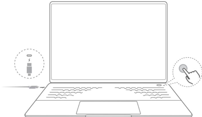
**首次开机时，必须先连接电源适配器，连接后，计算机会自动开机。**
